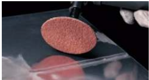
Produkt: A/O XTRA Schnellwechsel Schleifscheibe, Ø 76mm, Korn 36 Anwendung: Entfernen von Schweißraupen auf einer 6061 Aluminiumplatte
